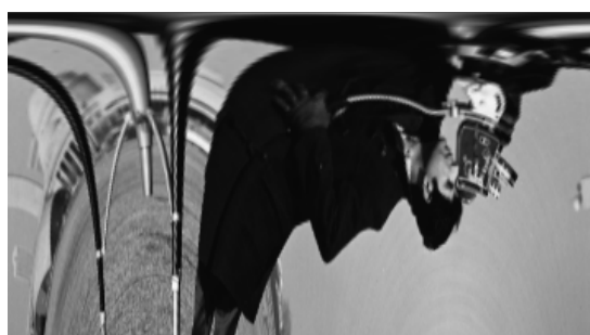
Rys.2 Rezultat przekształceń obrazu intensywności jasności ' cameraman.tif ' (256x256 pikseli) na obraz we współrzędnych biegunowych (200 gradacji długości promienia wodzącego, rozciągającego się pionowo, oraz 360 gradacji kąta wodzącego rozciągającego się na obrazie wynikowym poziomo)
